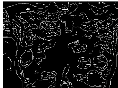
شکل ۹: لبه برداری از اندام‌های داخل تصویر حرارتی
